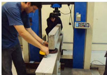
Rompimento de vigas de concreto armado - semana acadêmica
