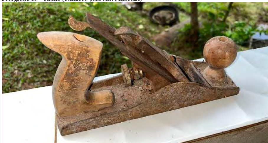
Fotografia 13 – Plaina (utilizada para alisar madeira)
