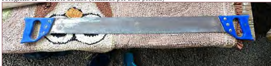
Fotografia 12 – Serrote de mão (utilizado por duas pessoas)
