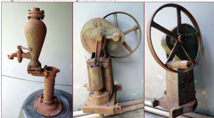
Fotografias 28, 29 e 30– Bomba d'água (com torneira)
