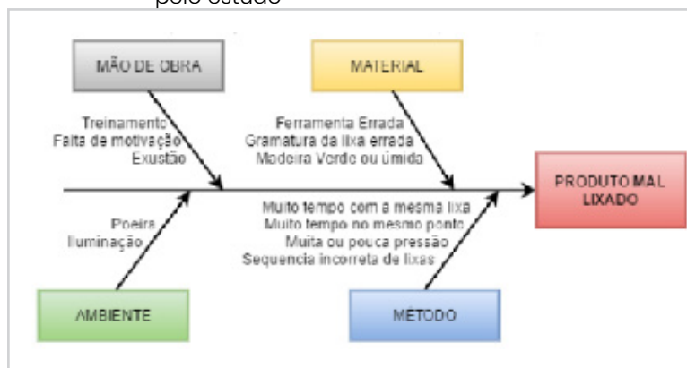
Diagrama 1 – Diagrama de Causa e Efeito de Ishikawa para o processo de produção de móveis acompanhado pelo estudo
